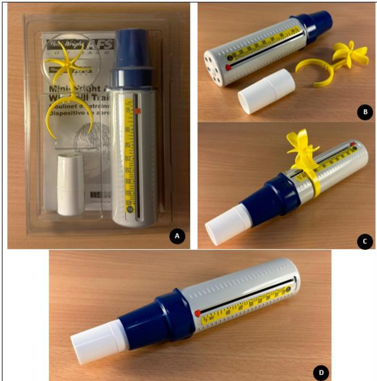
Figure 3 : Débitmètre de pointe, format enfant. Modèle : Mini-Wright AFS® Low Range Peak Flow Meter . 1A – l’emballage du dispositif ; 1B – les composants du dispositif ; 1C – Le dispositif assemblé avec moulinet d’entraînement. 1D – Le dispositif assemblé et prêt à être utilisé. NB : veuillez noter le curseur de couleur rouge qui indique la valeur mesurée. (Photographies réalisées aux HUG)
