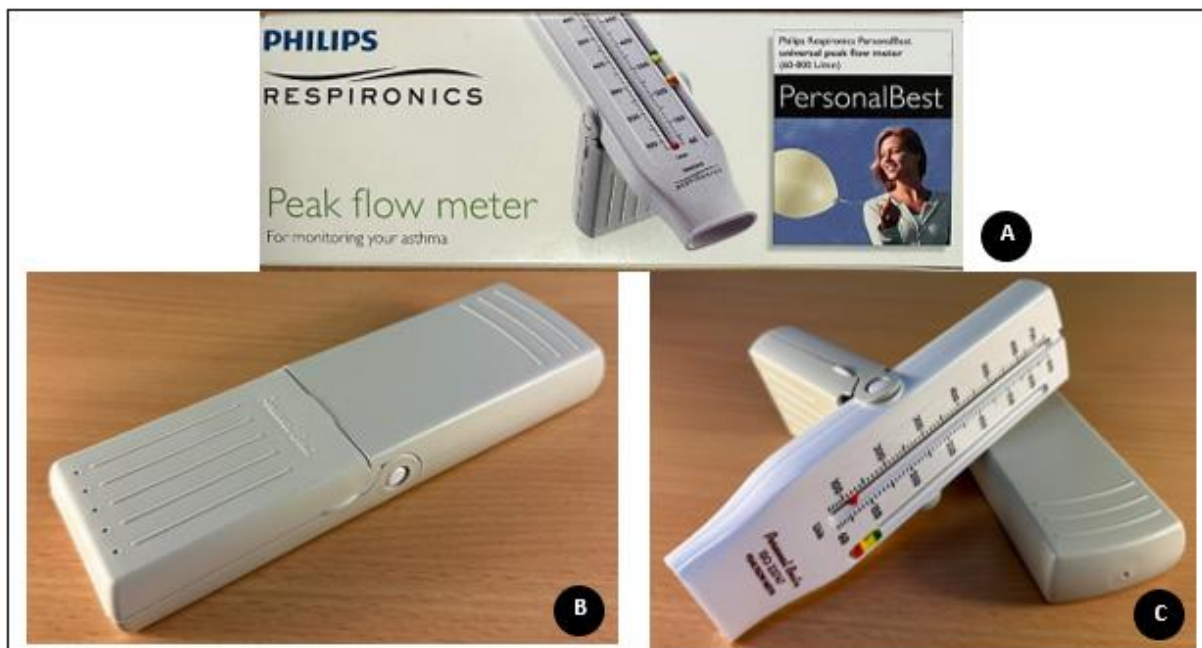
Figure 2 : Débitmètre de pointe, format adulte. Modèle : PersonalBest® de Philips®. 1A – l’emballage du dispositif ; 1B – le dispositif fermé avec couvercle ; 1C – Le dispositif avec couvercle enlevé et prêt à être utilisé. NB : veuillez noter le curseur de couleur rouge qui indique la valeur mesurée. (Photographies réalisées aux HUG)
