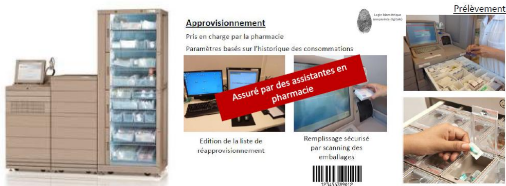
Figure 1 : Principe de fonctionnement d'une armoire à pharmacie automatisée (APA)
