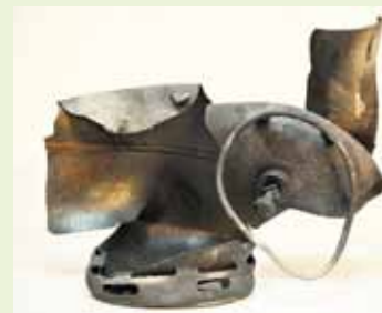
La bonbonne qui a explosé sur le chantier de la Maternité.
