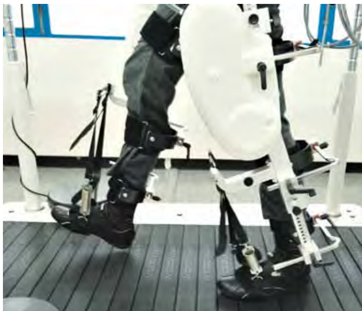
Lokomat porte le patient dans un harnais au-dessus d'un tapis roulant.
