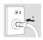
Brancher le manchon du tuvau d'aspiration sur la douille collectrice de gaz du système
