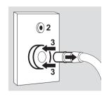
3 Appuyer sur la douille de déverrouillage et retirer en même temps le raccord de la prise de prélèvement. Le raccord est désaccouplé l'aspiration est désactivée. 2 Le voyant n'est plus vert.
